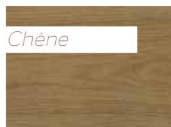
Le chêne commun, sessile ou pédonculé (*Quercus robur*) est un bois brun, légèrement jaune et veiné, au fil droit et au grain grossier. Il a une très forte durabilité naturelle sans traitement\* et des caractéristiques mécaniques permettant un usage en structure. Il provoque la corrosion des métaux ferreux en milieu humide.
