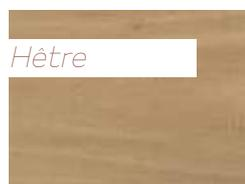
Le hêtre (*Fagus sylvatica*) est un bois blanc jaunâtre à brun rougeâtre clair, uniforme, au fil droit à peu ondulé et au grain fin. Il a une faible durabilité naturelle sans traitement\* et des caractéristiques mécaniques particulièrement bonnes. C'est un bois fissile et qui se laisse bien cintrer après étuvage.
