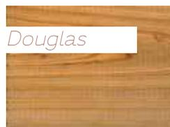
Le douglas ou pin d'Orégon (*Pseudotsuga menziesii*) est un bois brun-rouge plus ou moins prononcé, nettement veiné, au fil droit et au grain moyen à grossier. Il a une forte durabilité naturelle sans traitement\* et des caractéristiques mécaniques propices à un usage en structure. Il a des nœuds parfois gros et foncés.
