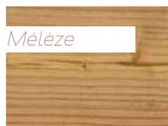
Le mélèze (*Larix europaea*) est un bois rosâtre plus ou moins prononcé, nettement veiné, au fil droit et au grain moyen. Il a une forte durabilité naturelle sans traitement\* et des caractéristiques mécaniques permettant une utilisation en structure. C'est un bois fissile avec des nœuds assez durs parfois peu adhérents.
