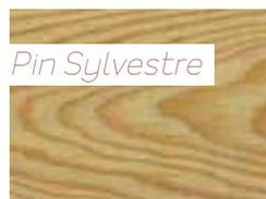
Le pin sylvestre (*Pinus sylvestris*) est un bois brun-rouge plus ou moins prononcé, nettement veiné, au fil droit et au grain fin à moyen. Il a une forte durabilité naturelle sans traitement\* et des caractéristiques mécaniques permettant un usage en structure. Il a des nœuds assez durs parfois peu adhérents.
